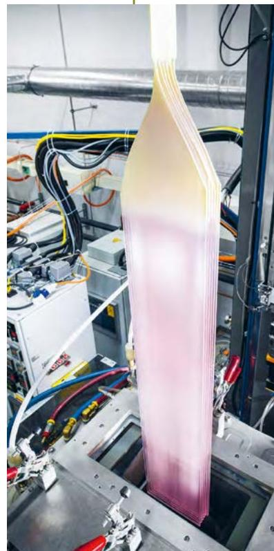
Comparé au procédé Verneuil, qui utilise de l'hydrogène et de l'oxygène comme énergie de procédé, le procédé EFG permet un processus de production avec moins d'émissions grâce à son fonctionnement avec une part significative d'électricité de provenance photovoltaïque.
